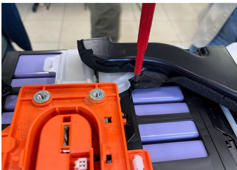
Figura 15 – Sistema de gerenciamento térmico localizado sobre os packs dianteiros
