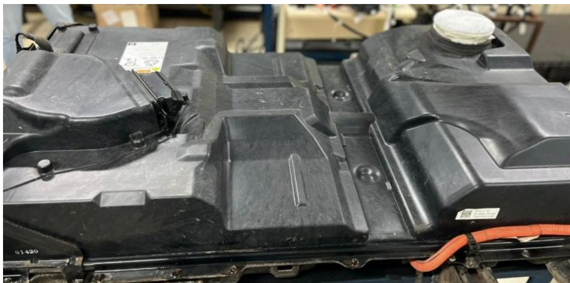
Figura 12 – Banco de baterias instalado sob o veículo depois da remoção
