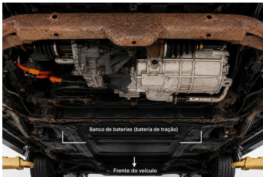
Figura 9 – Localização do banco de baterias sob o assoalho do i-MiEV
