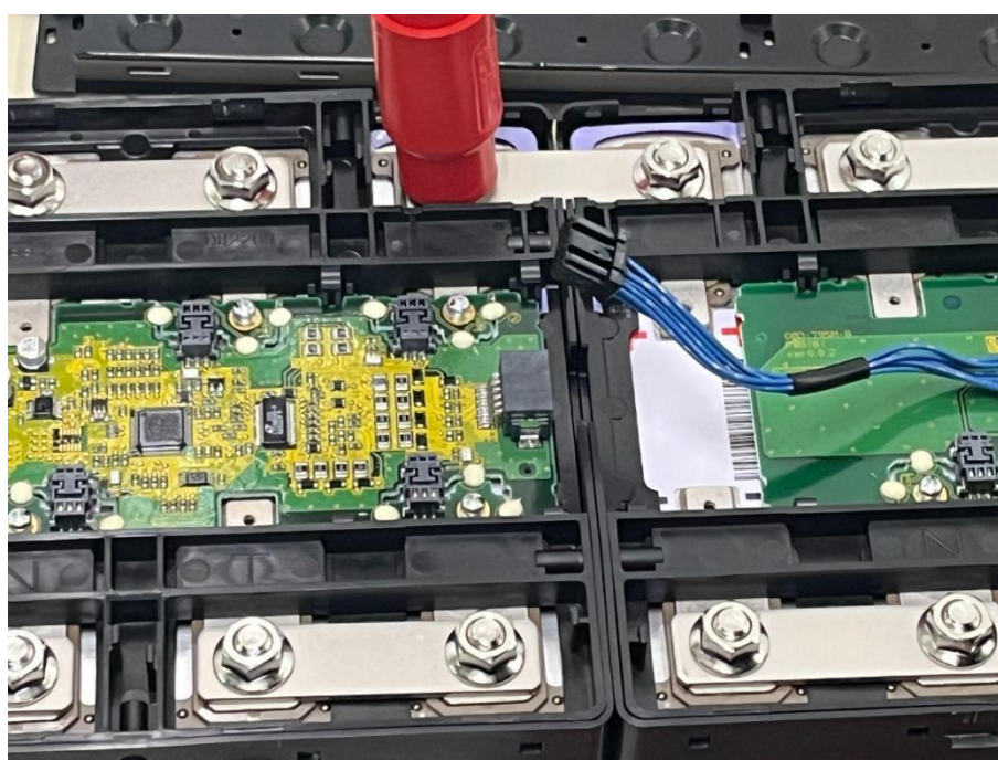
Figura 20 – Desconexão dos módulos de monitoramento e terminais de potência
