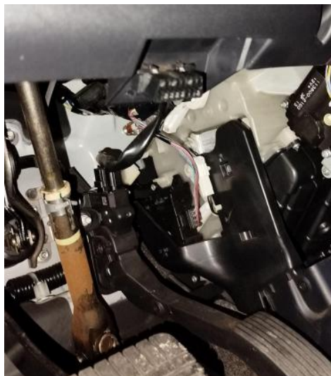
Figura 10 – Localização da porta OBD-II utilizada para diagnóstico do veículo
