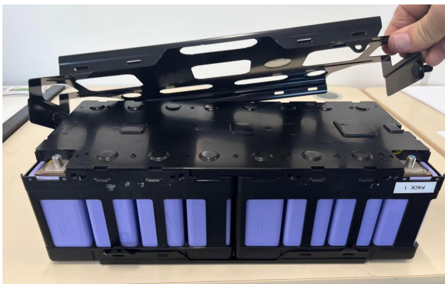
Figura 19 – Etapas iniciais da desmontagem dos packs de baterias
