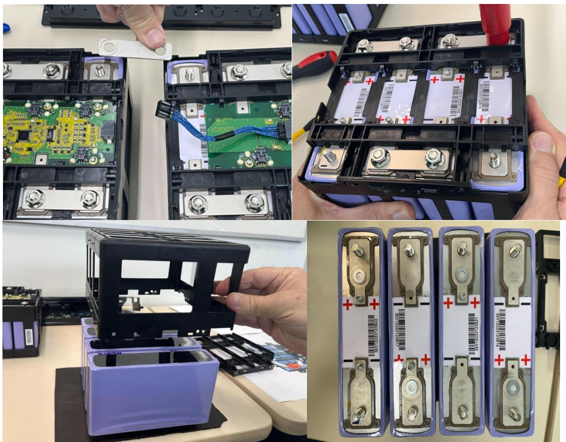
Figura 21 – Placas eletrônicas de monitoramento e conexões internas do pack
