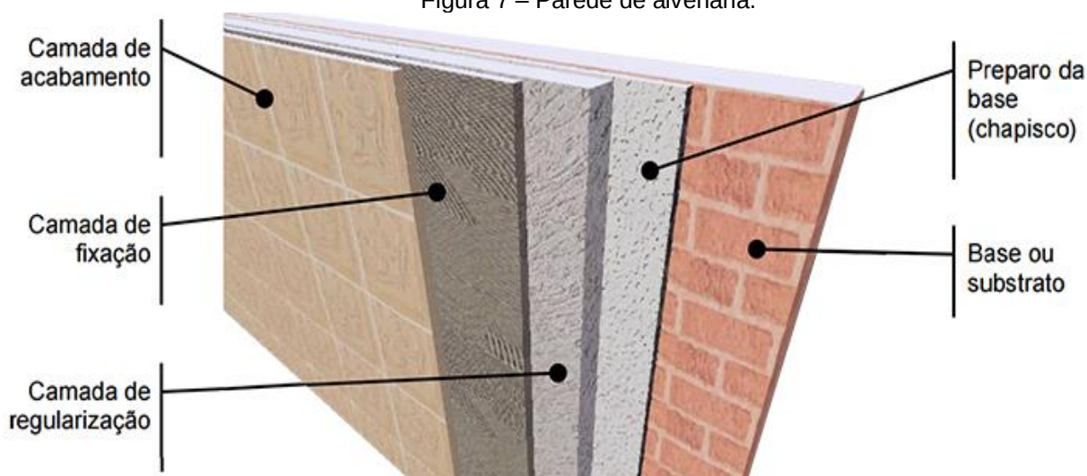
Figura 7 – Parede de alvenaria.
