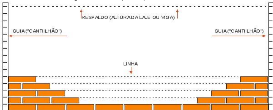
Figura 8 – Execução de parede em alvenaria.
