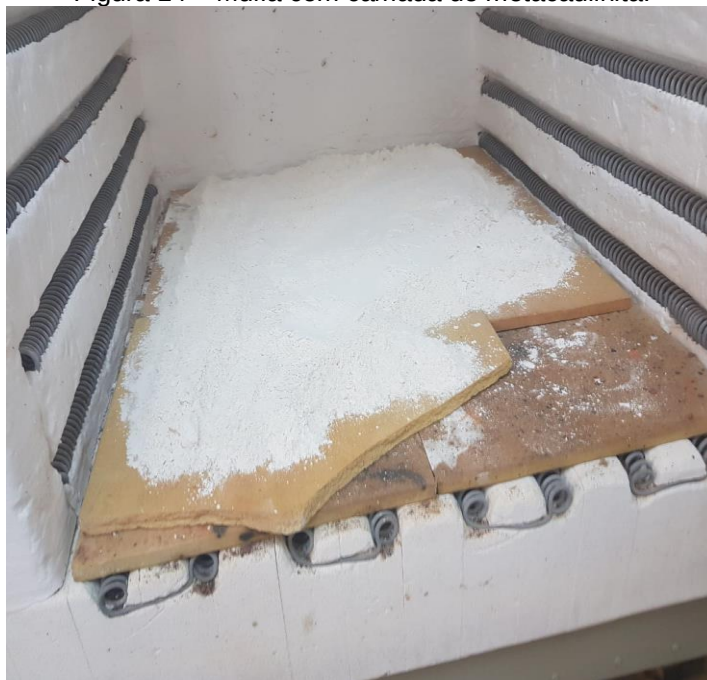
Figura 14 – Mufla com camada de metacaulinita.
