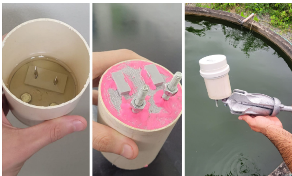
Figura 26 - Protótipo para teste de vedação
