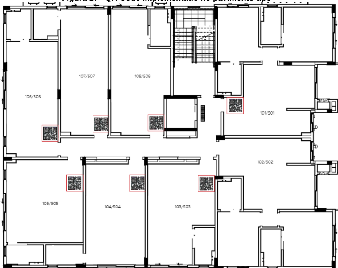
Figura 17– QR Code implementado no pavimento tipo
