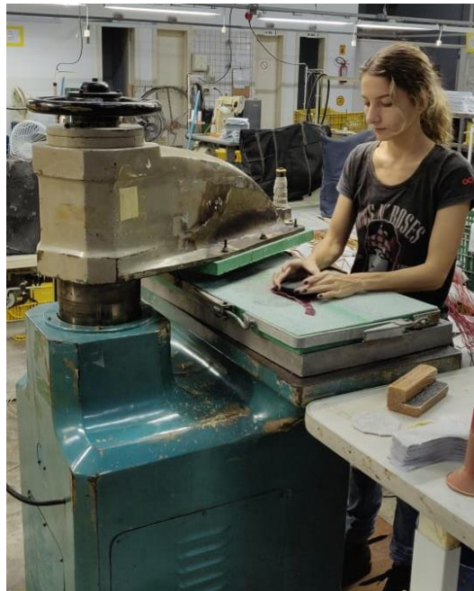
Figura 3 – Balancim de corte hidráulico sendo usado para o recorte das tiras
