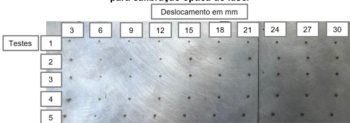
Figura 19 - Marcação dos pontos de impacto do feixe a diferentes distâncias para calibração óptica do laser
