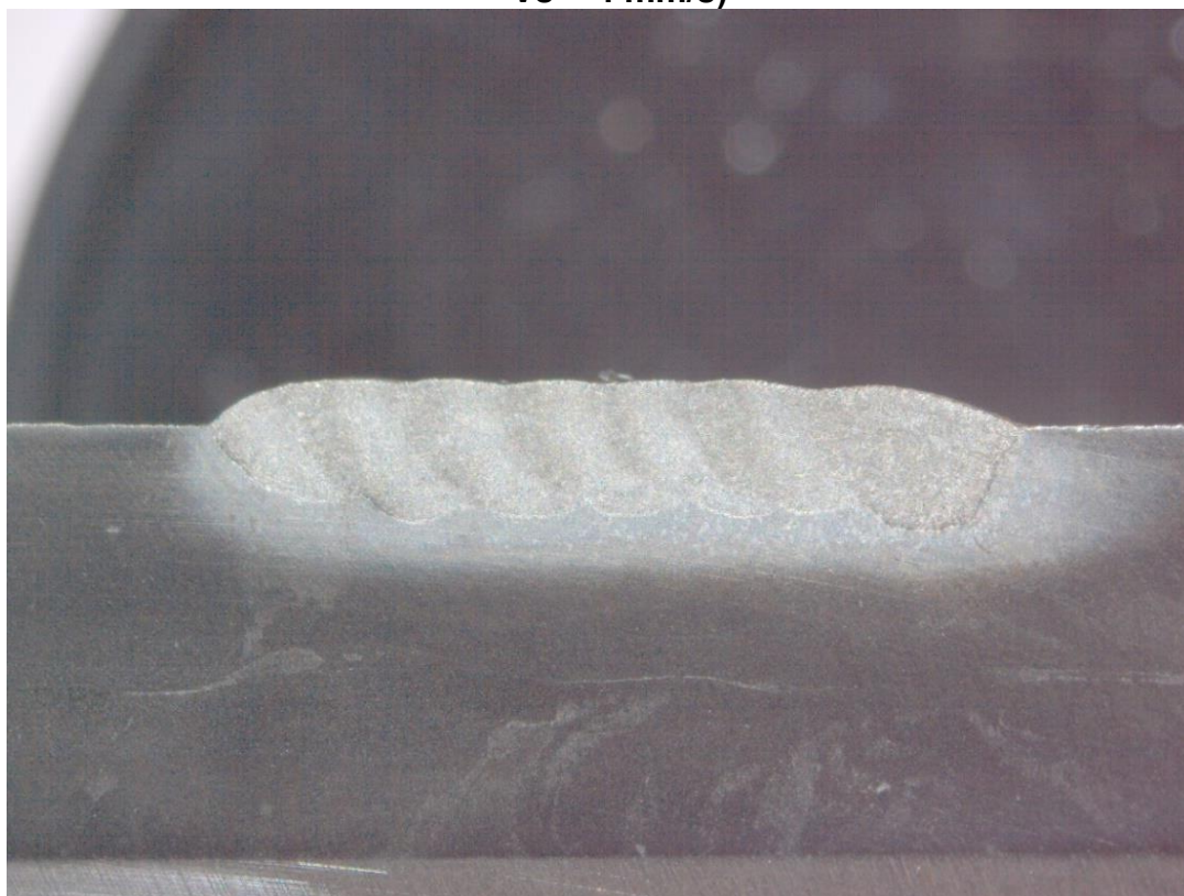
Figura 29 - Camada depositada com 30% de sobreposição, ( V_a = 10 mm/s, V_s = 4 mm/s)
