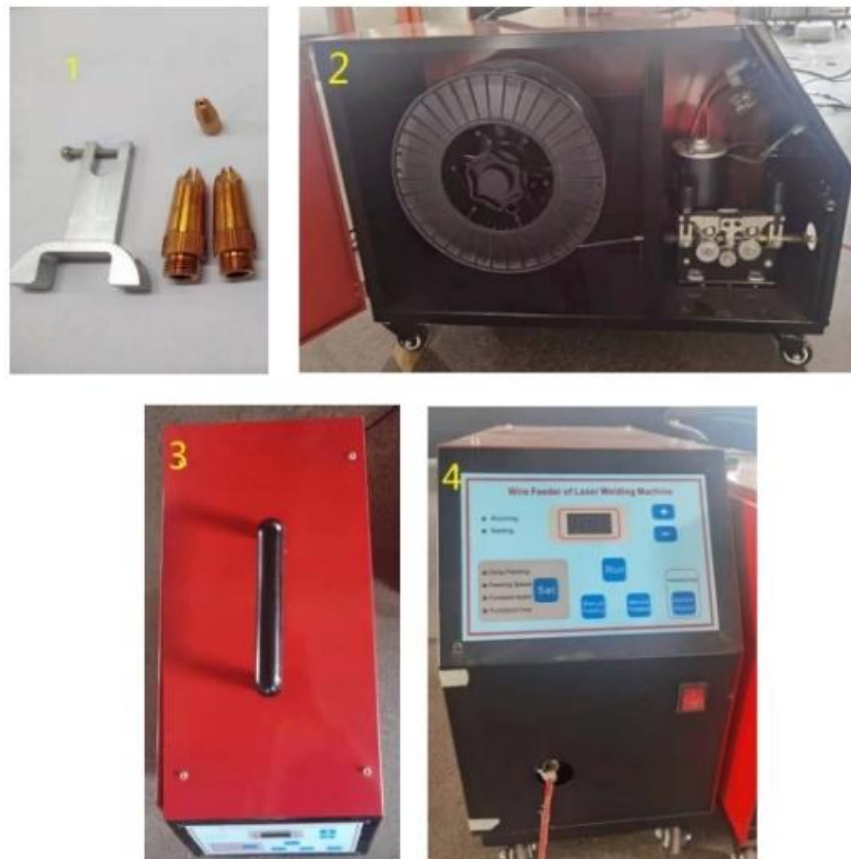
Figura 8 - (1) bicos e suporte para direcionamento do arame (2) parte interna alimentador arame, (3) alimentador de arame, (4) interface alimentador de arame
