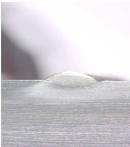
Figura 25 - Macrografia do cordão de solda correspondente aos parâmetros ( V_a = 10 mm/s, V_s = 4 mm/s)
