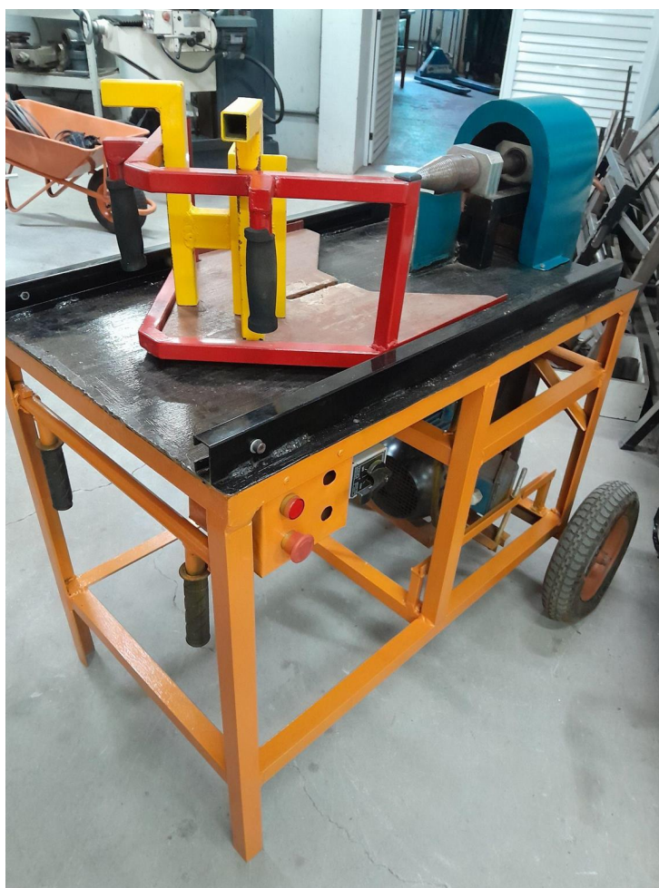
Figura 15 – Dispositivo de alimentação instalado no Rachador do IFSC.
