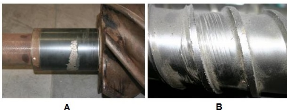
Figura 4 – Desgaste abrasivo em elementos de transporte de fluidos: A) Eixo de bomba; B) Rosca transportadora
