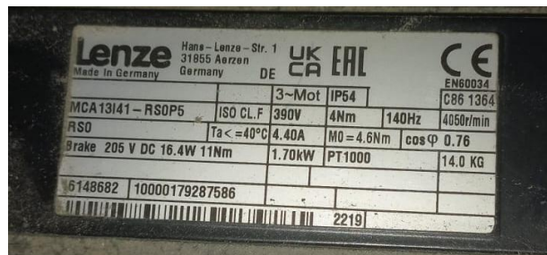
Figura 13. Placa de Identificação Servomotor Lenze
