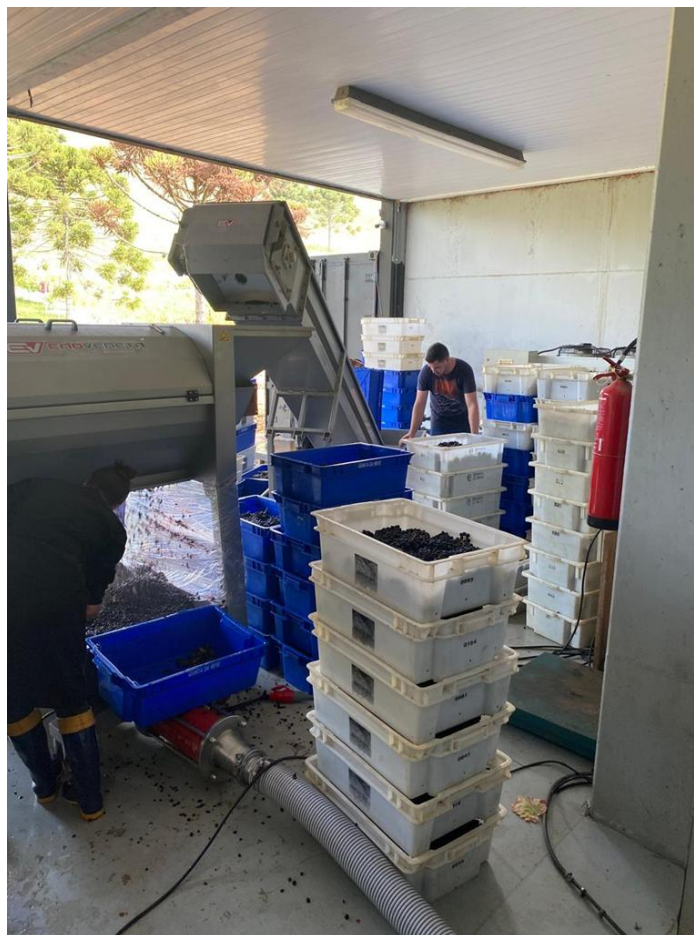
Figura 4. Processamento da uva – desengaço, seleção e bomba mono para bagaço
