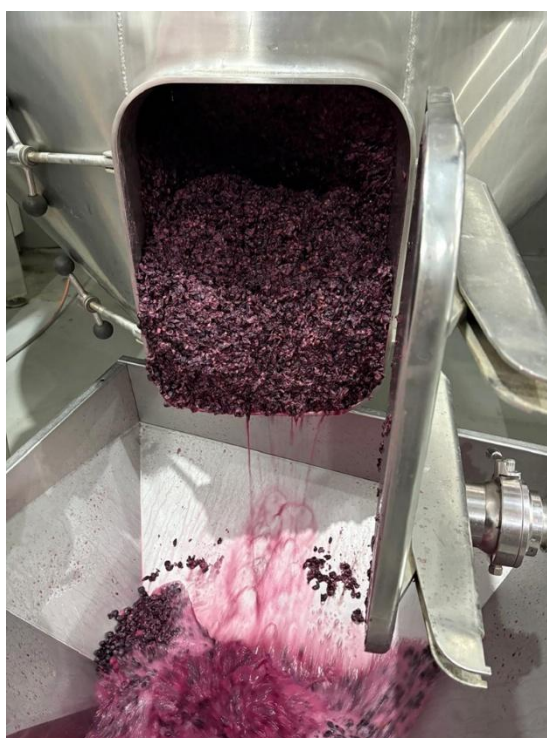
Figura 7. Descuba de tanque, bagaço sendo retirado pela porta inferior do tanque e enviado para prensagem.
