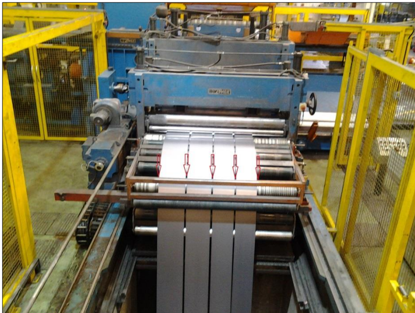
Figura 43 - Aplicação de Anéis Separadores de Realização de Abertura de Fenda em Tiras Cortadas Fonte: Autor (2013)
