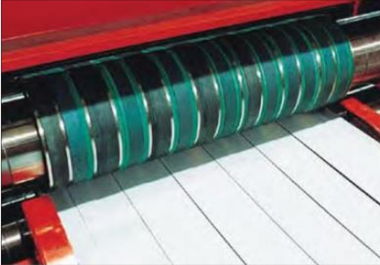
Figura 42 - Exemplo de Cabeçote de Corte Montado com Anéis Expulsadores em toda a Extensão do Eixo de Corte Fonte: (RED BUD INDUSTRIES, 2007)
