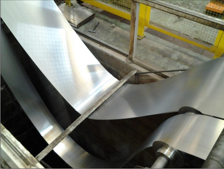
Figura 47 - Corte de Tiras de Aço com a Ocorrência de Variação no Tamanho do Looping Final
