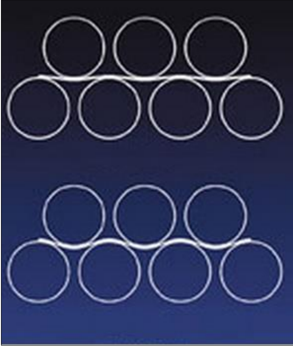
Figura 48 - Indicação de Funcionamento de um Conjunto Endireitador Fonte: (HEDRICK, 2002)
