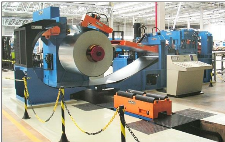
Figura 11 - Sistema Composto de Carro de Alimentação, Desbobinador e Conjunto de Alimentação Fonte: (DIVIMEC, 2010)
