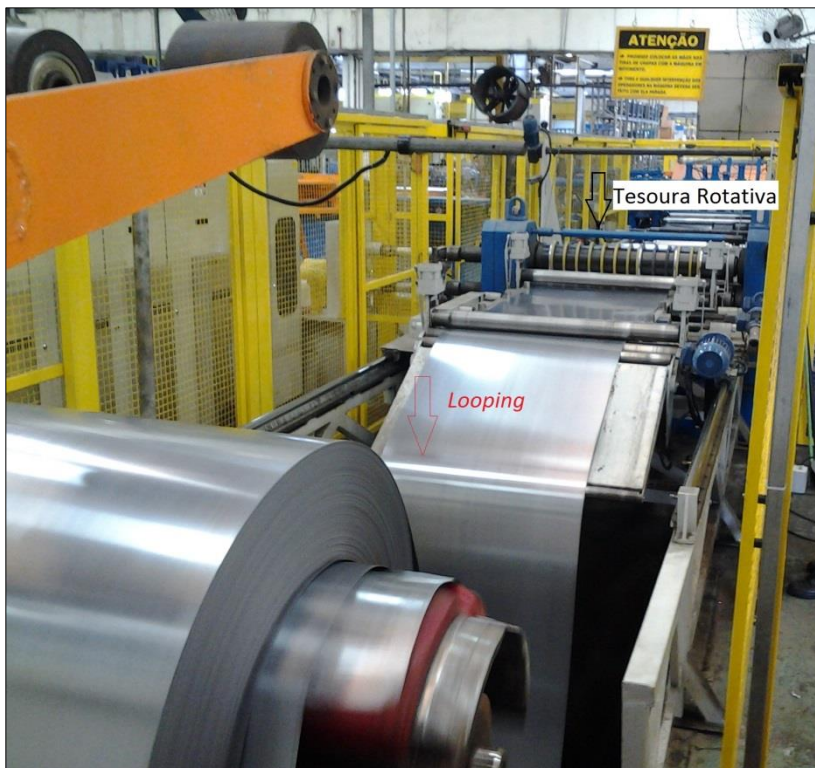
Figura 41 - Exemplo de Linha de Corte com Duplo Looping Fonte: Autor (2013)
