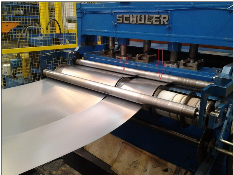
Figura 45 - Deformação Lateral da Tira Cortada ao Passar Através de Anéis Separadores
