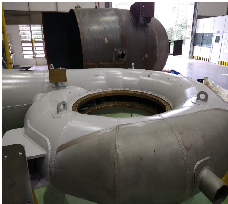
Figura 16: Caixa espiral posicionada no posto para montagem
