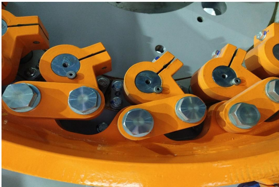
Figura 27: Conjunto de regulação da turbina
