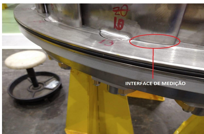
Figura 21: interface de medição para ajuste dos bronzes
