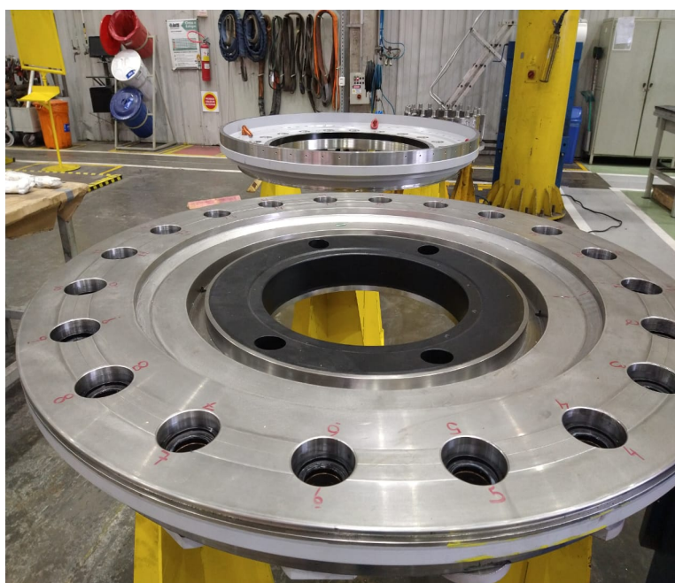
Figura 17: Tampas posicionadas para a montagem
