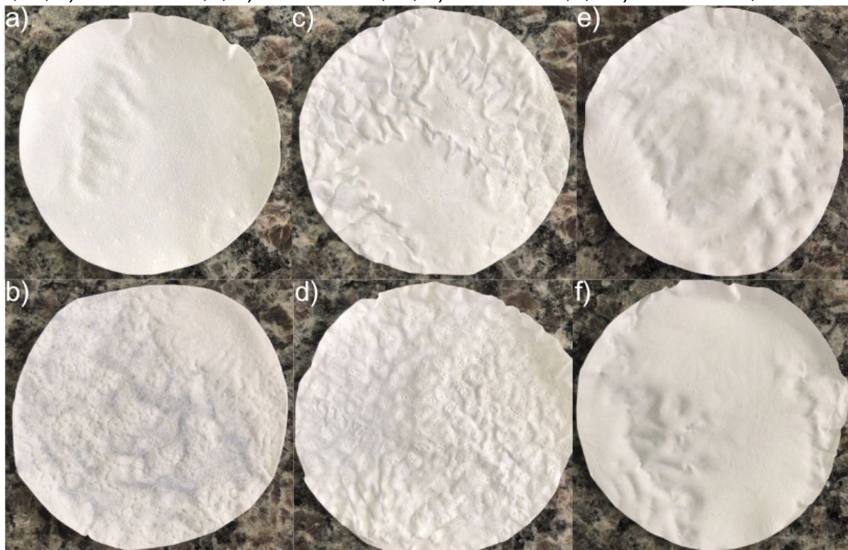
Figura 1 - Membranas poliméricas recobertas com \text{TiO}_2 ; a) PLA/MC 0,5; b) PLA/MC 0,25; c) PLA/GOH 0,5; d) PLA/GOH 0,25; e) PLA/PVP 0,5; e f) PLA/PVP 0,25
