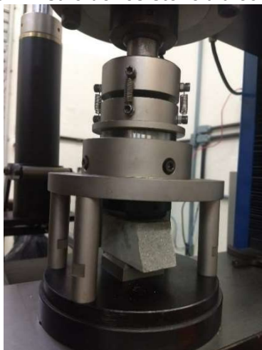
Figura 15 - Ensaio de resistência à compressão
