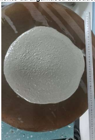
Figura 28 - Espalhamento da argamassa autoadensável com a/c = 0,85
