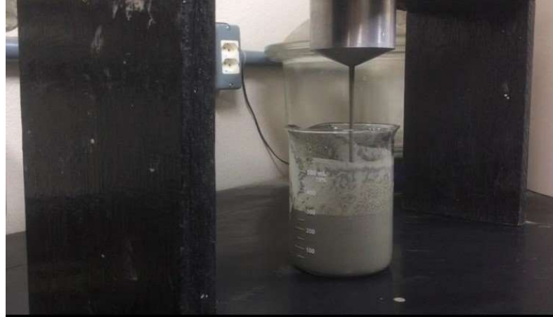
Figura 20 - Avaliação do tempo de escoamento no cilindro espanhol
