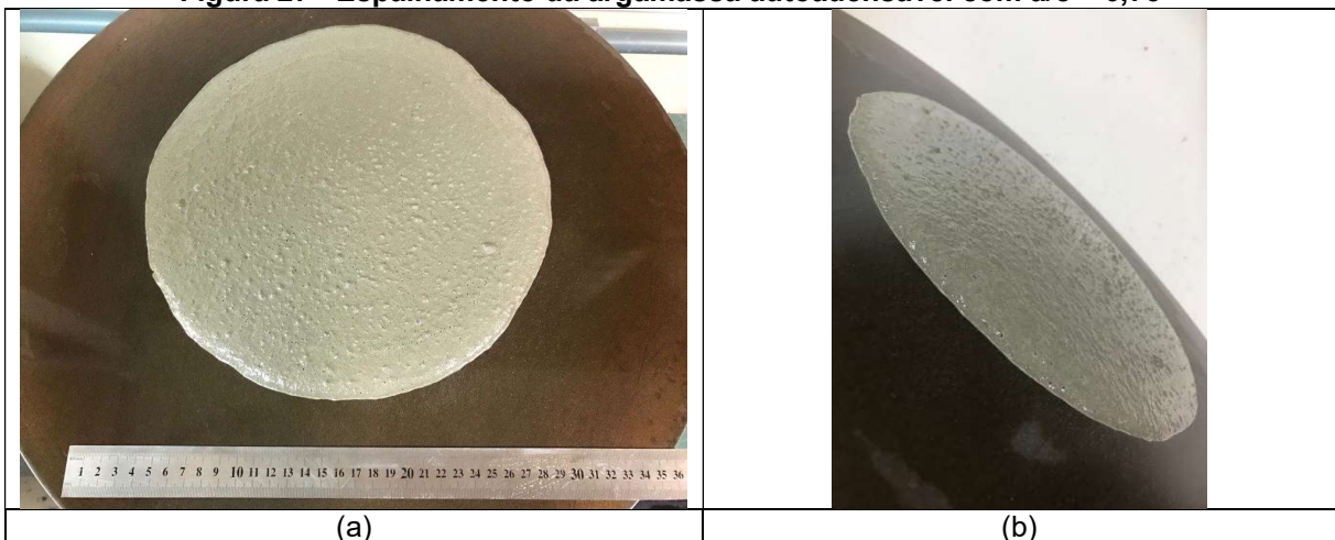
Figura 27 - Espalhamento da argamassa autoadensável com a/c = 0,73
