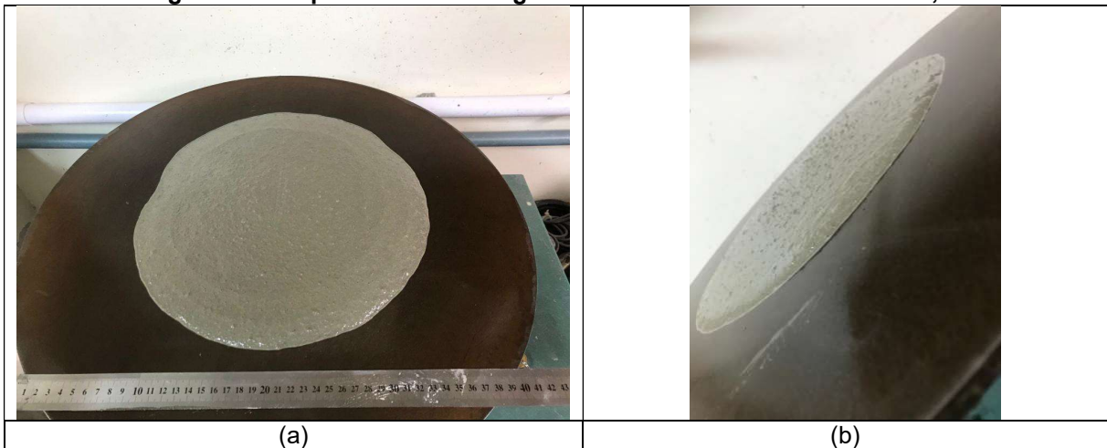
Figura 26 – Espalhamento da argamassa autoadensável com a/c = 0,60
