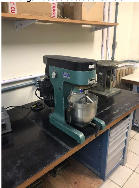
Figura 12 - Argamassadeira utilizada para o desenvolvimento das pastas cimentícia e das argamassas autoadensáveis
