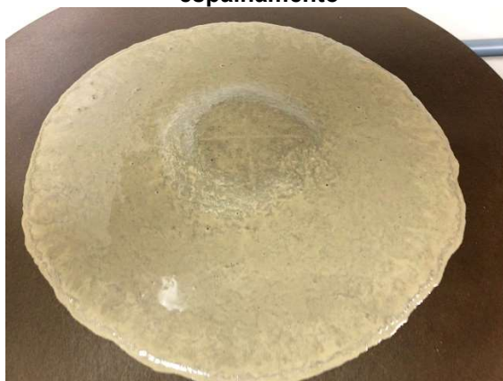
Figura 4 - Argamassa com sinais de exsudação e segregação durante o ensaio de espalhamento
