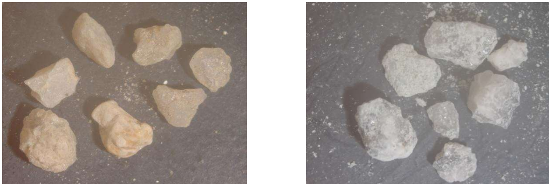
Figura 19 - Imagem dos grãos de areia de rio (a) e areia de britagem (b) retidas na peneira #2,4 mm
