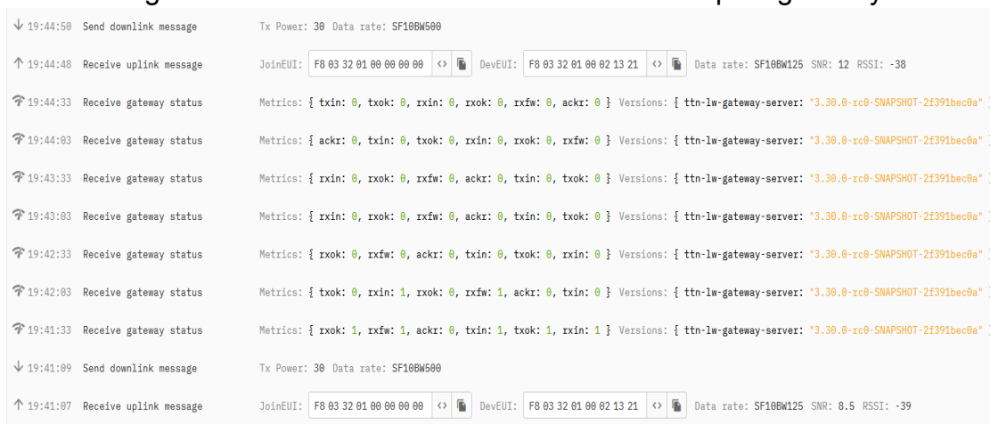
Imagem 13 – Interface do servidor TTN mostrando o dispositivo NIT21LI e registrando os dados de RSSI e SNR medidos pelo gateway
