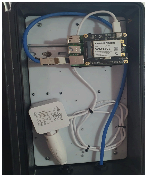
Imagem 12 – Gateway Raspberry Pi 4B com o módulo LoRa da Seedstudio
