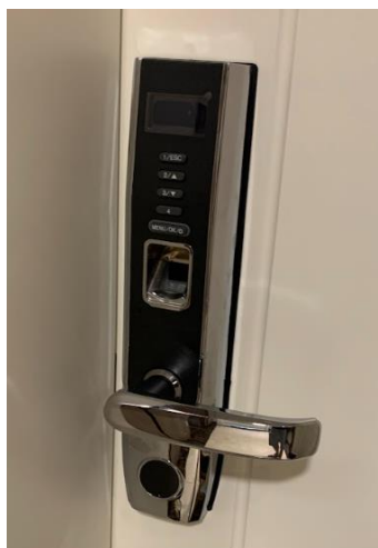
Figura 22 - Foto Maçaneta de Leitura Biométrica
