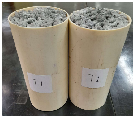
Figura 12 -Corpos de prova moldados em tubo de PVC
