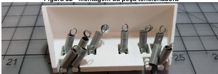
Figura 32 - Montagem da peça tensionadora
