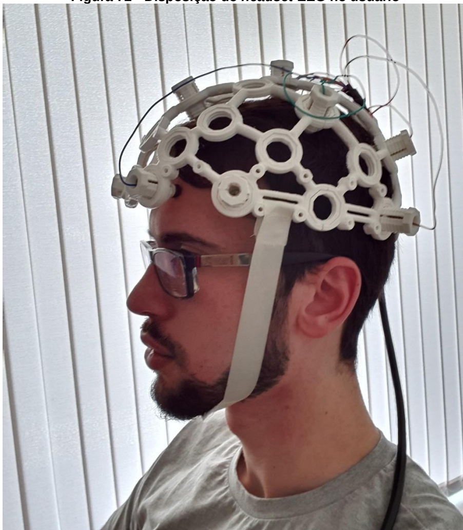
Figura 72 - Disposição do headset EEG no usuário
