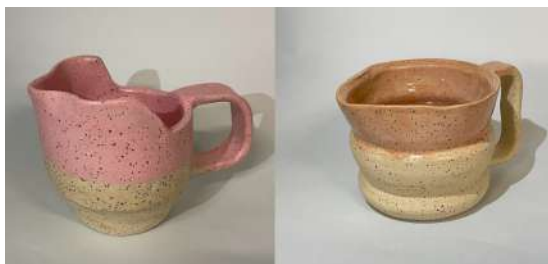
Figura 24 - Teste de monoqueima de massa Granito rezende
