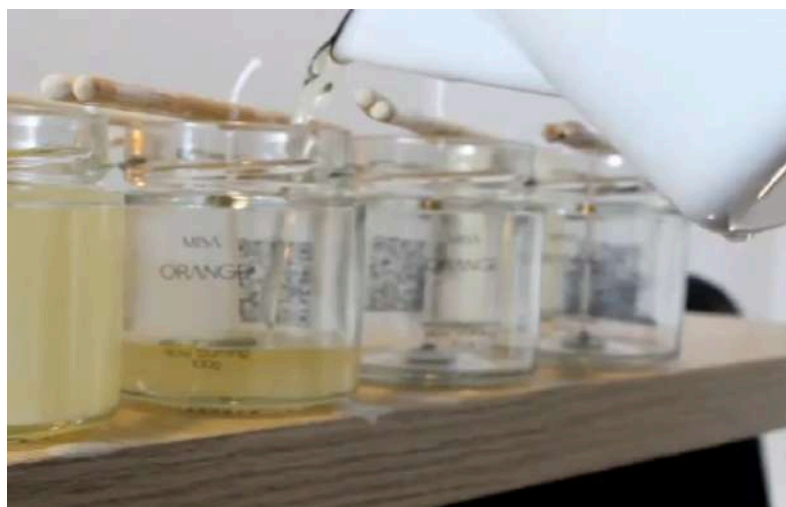
Figura 4 - Técnica hand poured utilizada na produção das velas da Misacare
