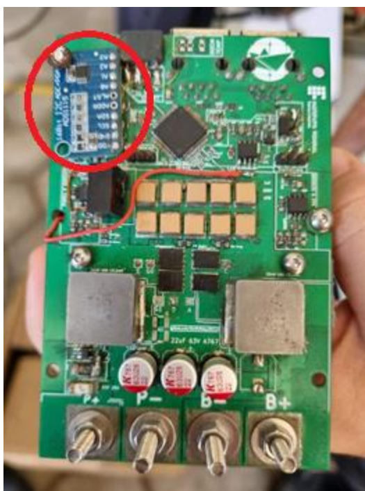
Figura 23 – Adaptações na placa do MCC
