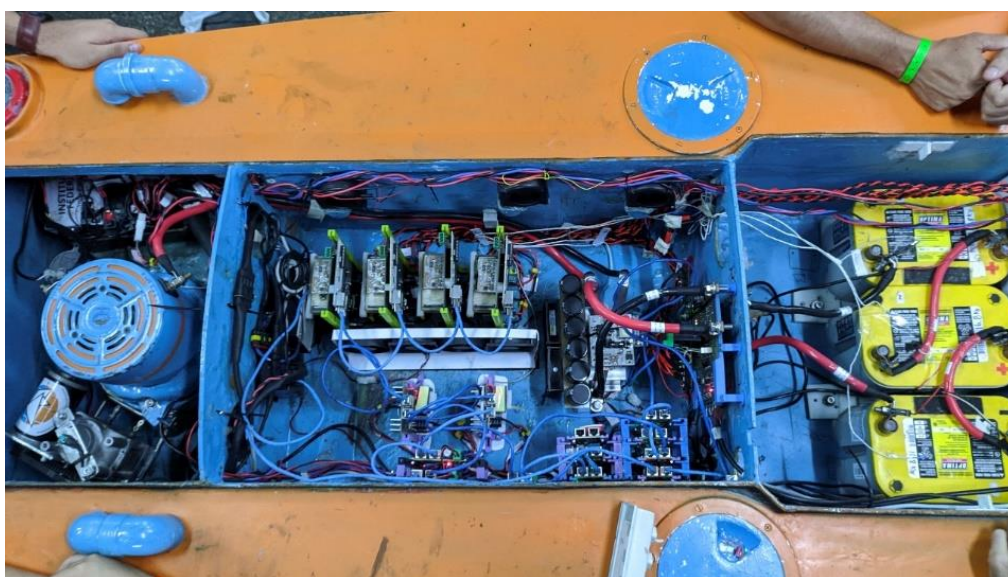
Figura 15 – Compartimento da eletrônica da embarcação Zênite Solar
