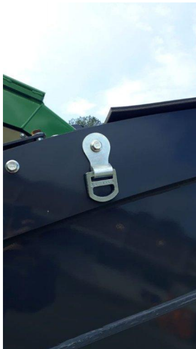
Figura 2 - Ponto de Ancoragem fixado na lança do equipamento
