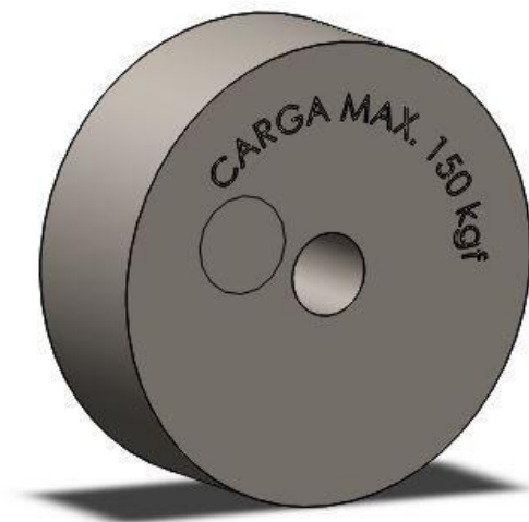
Figura 29: Elemento bolacha soldável a estrutura
