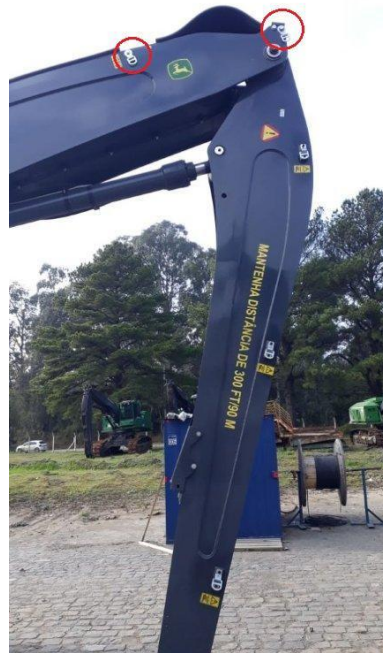
Figura 3 - Visão geral local onde vão alocados pontos de ancoragem
