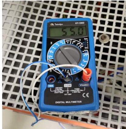
Figura 28 - Tensão DC nos terminais da carga com gerador BLDC a 7109 rpm e carga resistiva de 5 \Omega
