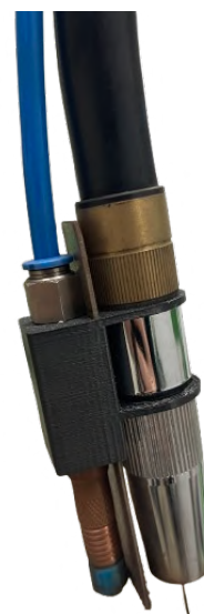
(b) Sistema encaixado na tocha GMAW
