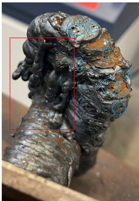
Figura 36 – Defeitos superficiais na primeira peça
