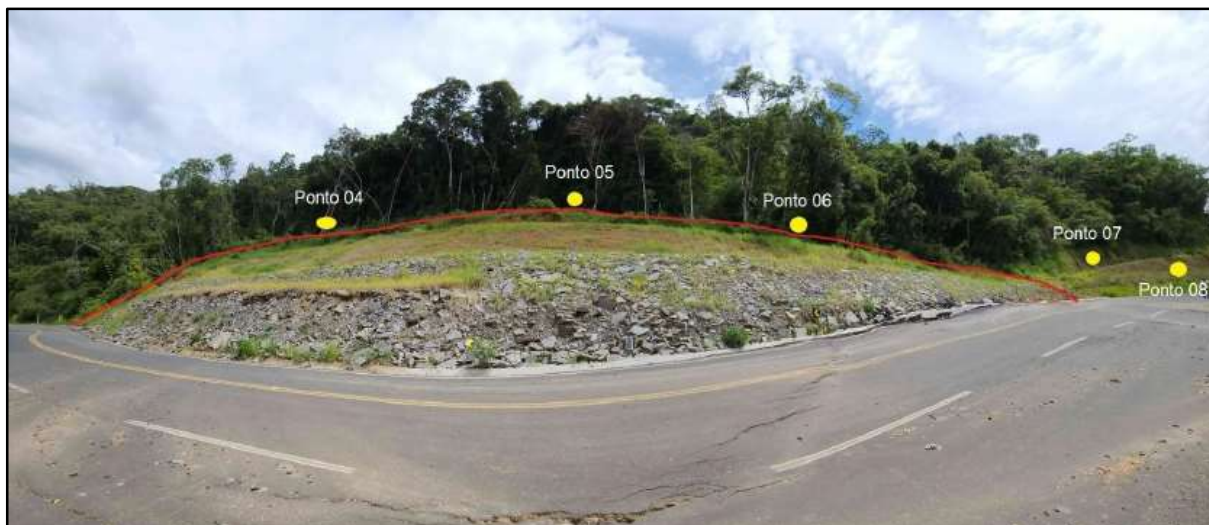
Figura 27 – Posição dos pontos para o ensaio de cisalhamento direto
