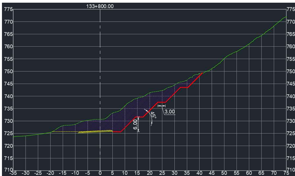
Figura 30 – Retaludamento 1:1 (Seção crítica – Civil 3D)
