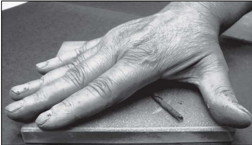
Figura 8 – Rolagem da massa de solo em uma placa de vidro para determinação do limite de plasticidade.
