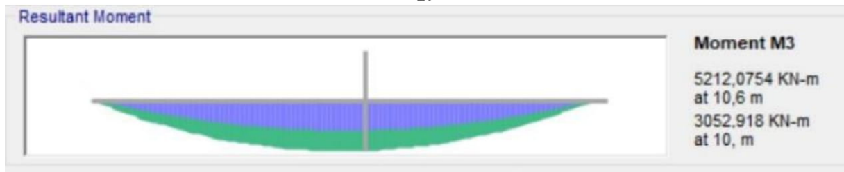
Figura 40 - Momento fletor SAP2000 (kN.m) - Sem transversina - 1,35PP+1,5TB L1
