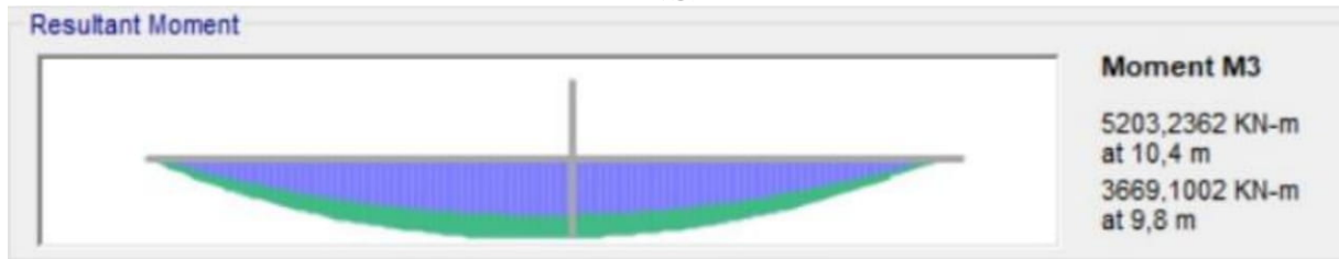
Figura 41 - Momento fletor CSiBridge (kN.m) - Sem transversina - 1,35PP+1,5TB L1
