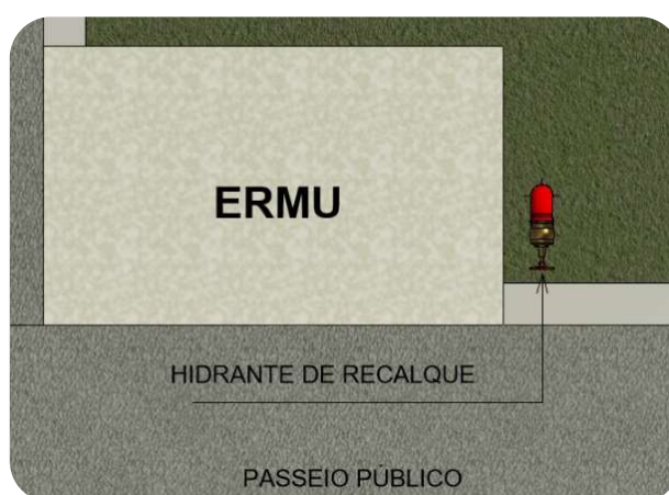
Figura 29 – Posição hidrante de recalque
