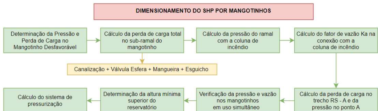
Figura 21 – Fluxograma de dimensionamento do SHP por mangotinhos
