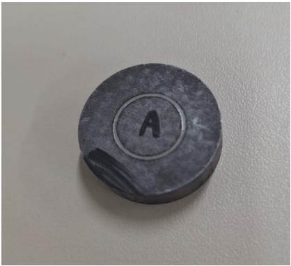
Figura 4: Amostra após o ensaio de desgaste por deslizamento, evidenciando a trilha de desgaste formada durante o teste e utilizada para avaliação da resistência ao desgaste do material.
