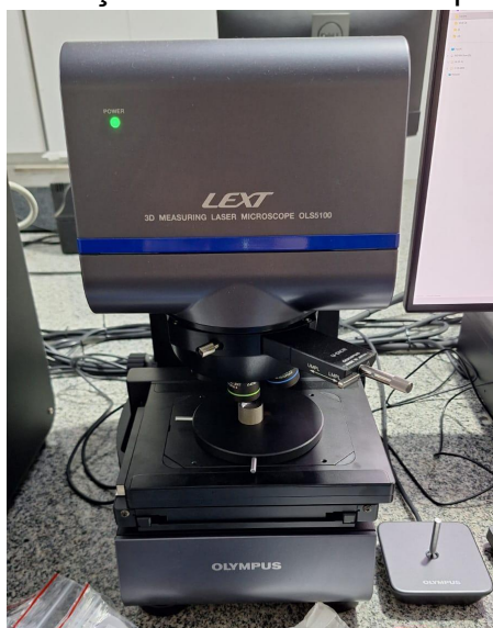
Figura 5: Microscópio confocal Olympus LEXT OLS5100 utilizado para a medição e caracterização tridimensional das pistas de desgaste.
