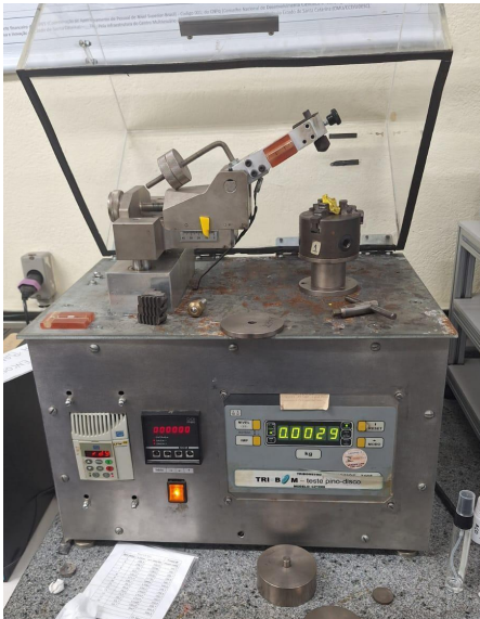
Figura 3: Tribômetro Tribom CZ1000 usado no ensaio de desgaste.
