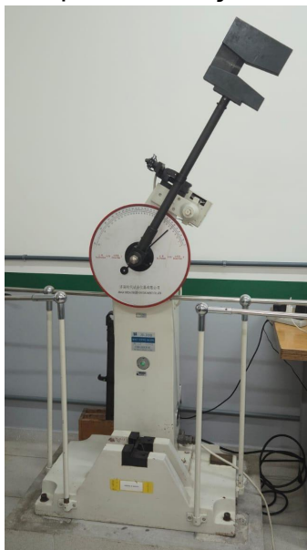
Figura 1: Pêndulo de impacto para realização do ensaio de impacto charpy.
