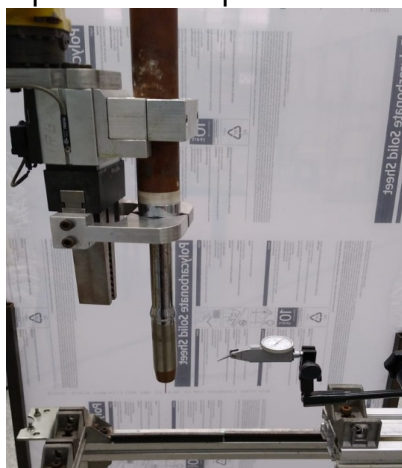
Figura 27 - Bancada de teste para medir repetibilidade
