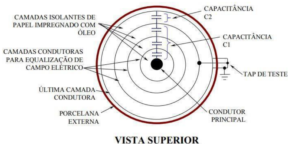
Figura 2.3 – Vista superior em corte da bucha capacitiva
