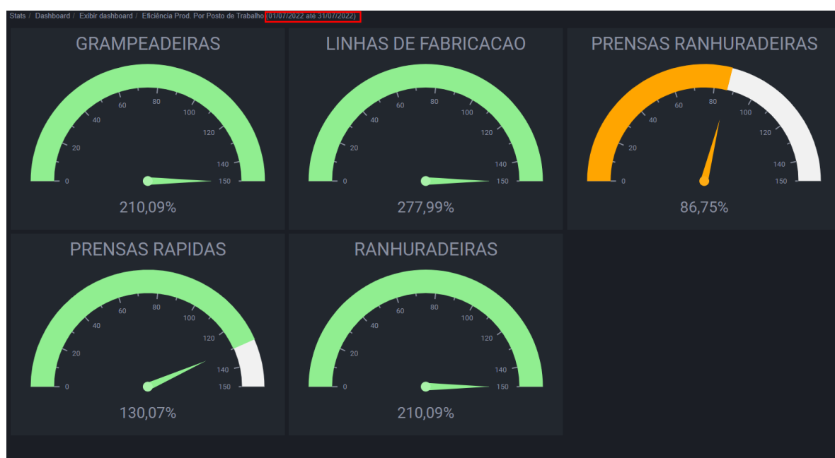
Figura 35 – Dashboard Eficiência produtiva por grupo Posto de Trabalho no período de 01/07/22 até 31/07/22 (Estamparia).
