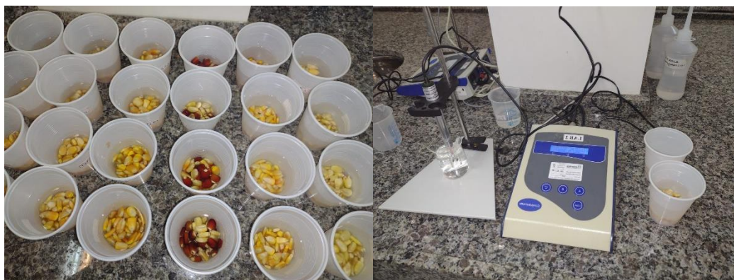
Figura 3 - Teste de condutividade elétrica de sementes de milho crioulo.
