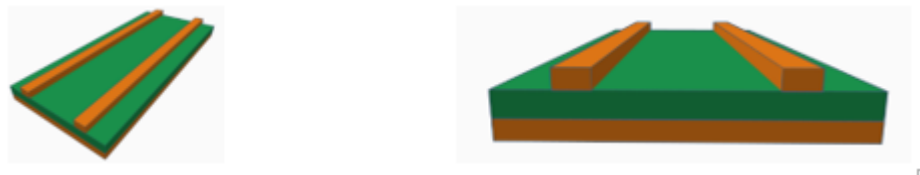
Figura 11 – Representação esquemática de duas trilhas paralelas com plano de referência inferior
