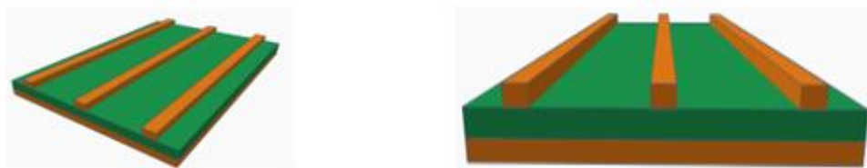
Figura 13 – Representação esquemática de trilhas paralelas com trilha de guarda com plano de referência inferior
