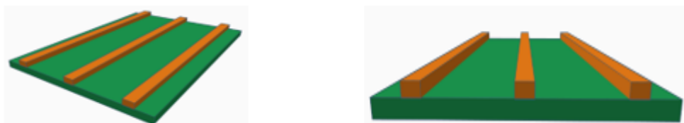
Figura 12 – Representação esquemática de trilhas paralelas com trilha de guarda sem plano de referência inferior
