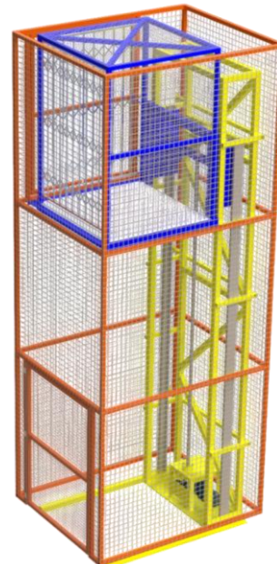
Fig. 8: Modelo 3D da plataforma elevatória.
