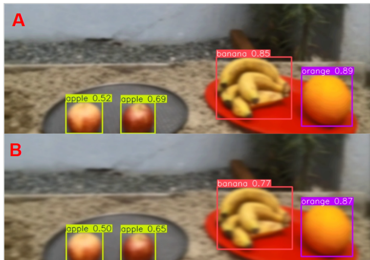
Figura 22 – Análise modelo yoloV8X - Desfoque em 10% e 15%
