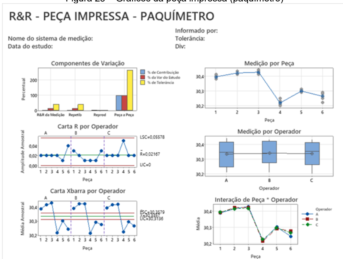
Figura 23 – Gráficos da peça impressa (paquímetro)
