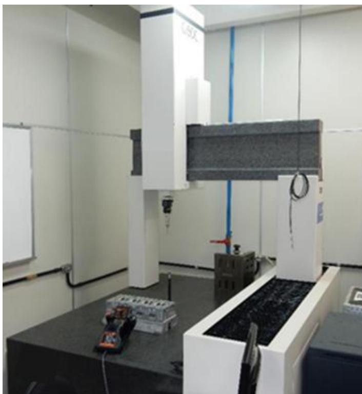
Figura 17 – Máquina de medição por coordenadas
