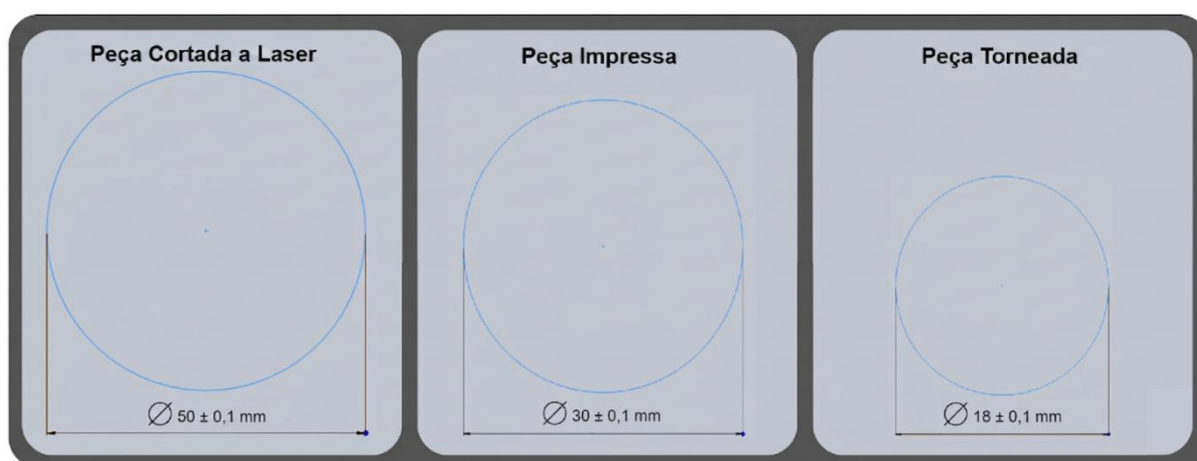
Figura 11 - Desenho da peça com a tolerância
