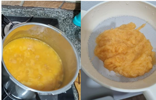
Figura 10: Processo de tingimento da paina com urucum
