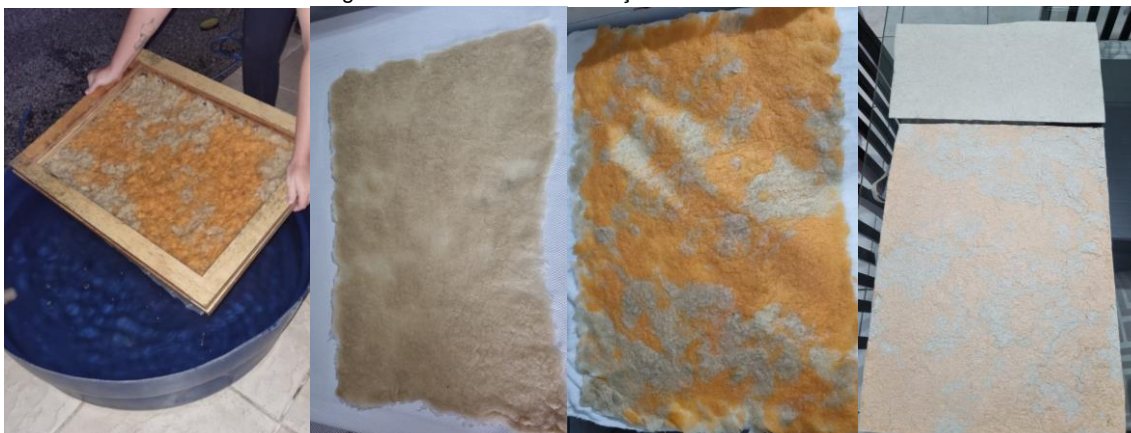
Figura 11: Processo de formação do tecido não tecido
