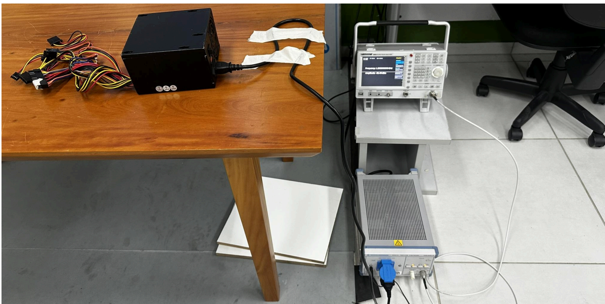
Figura 25 – Ensaio convencional Fonte ATX 500W
