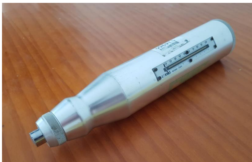
Figura 59 – Esclerômetro Schmidt Modelo N
