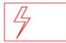
Quadro de distribuição de luz (QDL)
