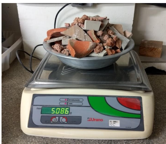
Figura 11 – Pesagem dos materiais separados
