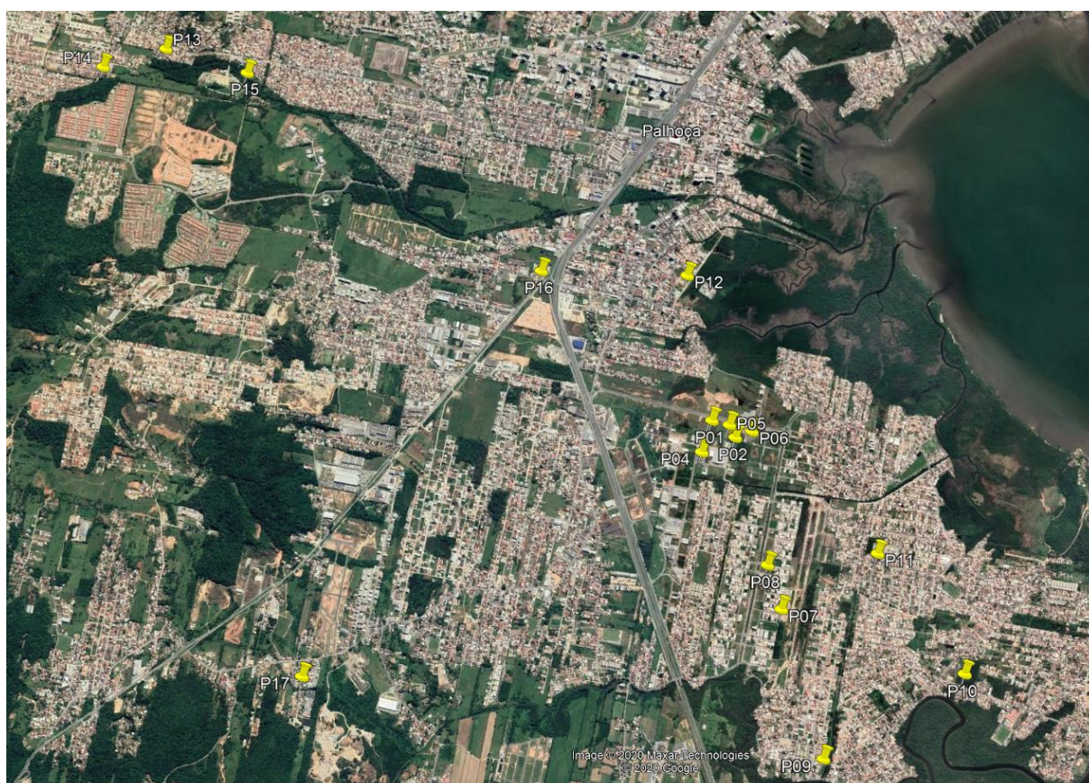
Figura 15 – Mapeamento das disposições irregulares de RCD em Palhoça
