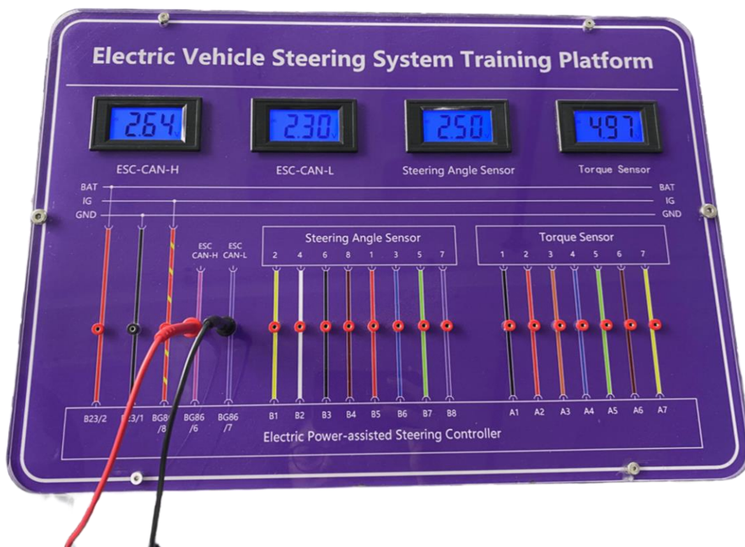
Figura 13 - Bancada de direção assistida com acesso a rede CAN
