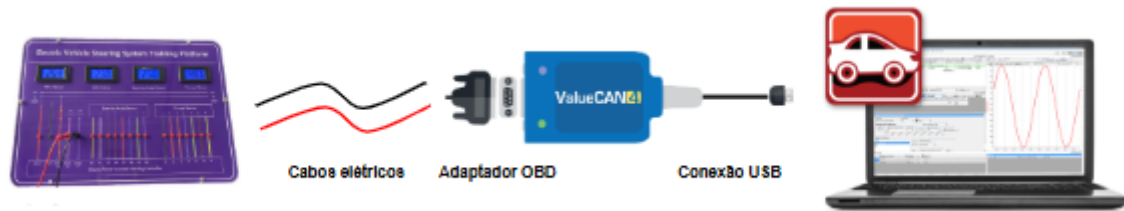
Figura 18 – Conexões elétricas entre os sistemas comerciais
