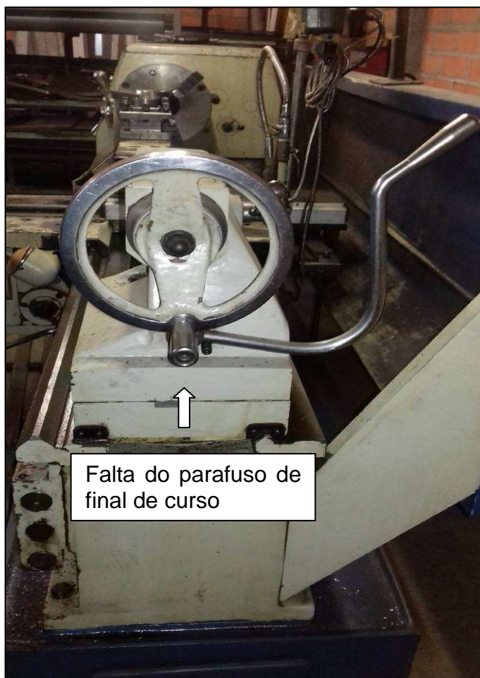
Figura 15 - Face lateral direita do torno CLEVER MODELO L-2660A, sem proteção.
