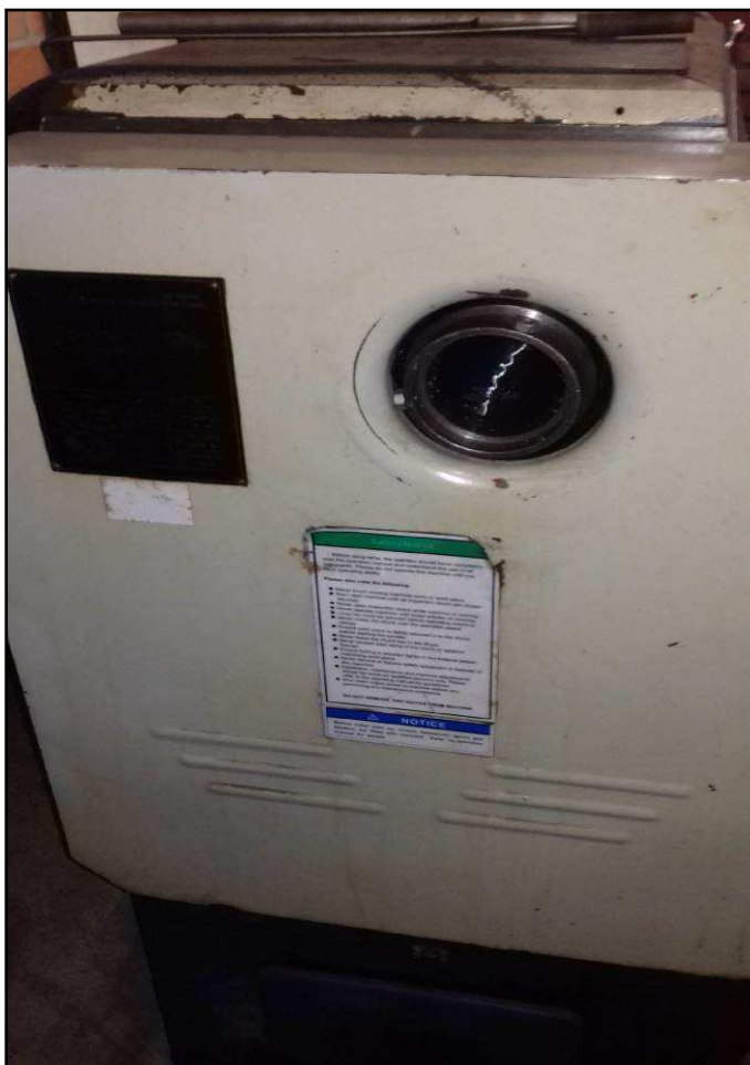
Figura 13 – Face lateral esquerda - Eixo árvore sem proteção para barras longas. Torno CLEVER MODELO L-2660A.
