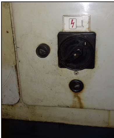
Figura 18 - Porta móvel com trava mecânica sem sistema de travamento mecânico da chave torno CLEVER MODELO L-2660A.
