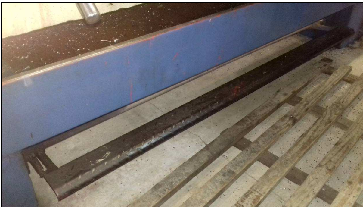
Figura 7 - Estrado de madeira utilizado como apoio para os pés que deveria ser menos espaçado para dar boa estabilidade e estar em perfeitas condições.
