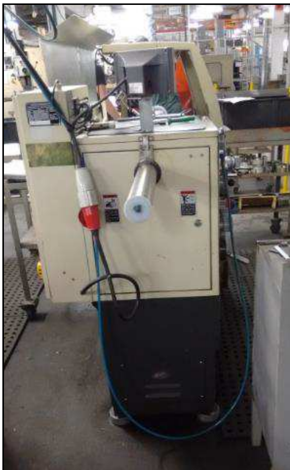
Figura 14 - Exemplo de eixo árvore com proteção para torno.
