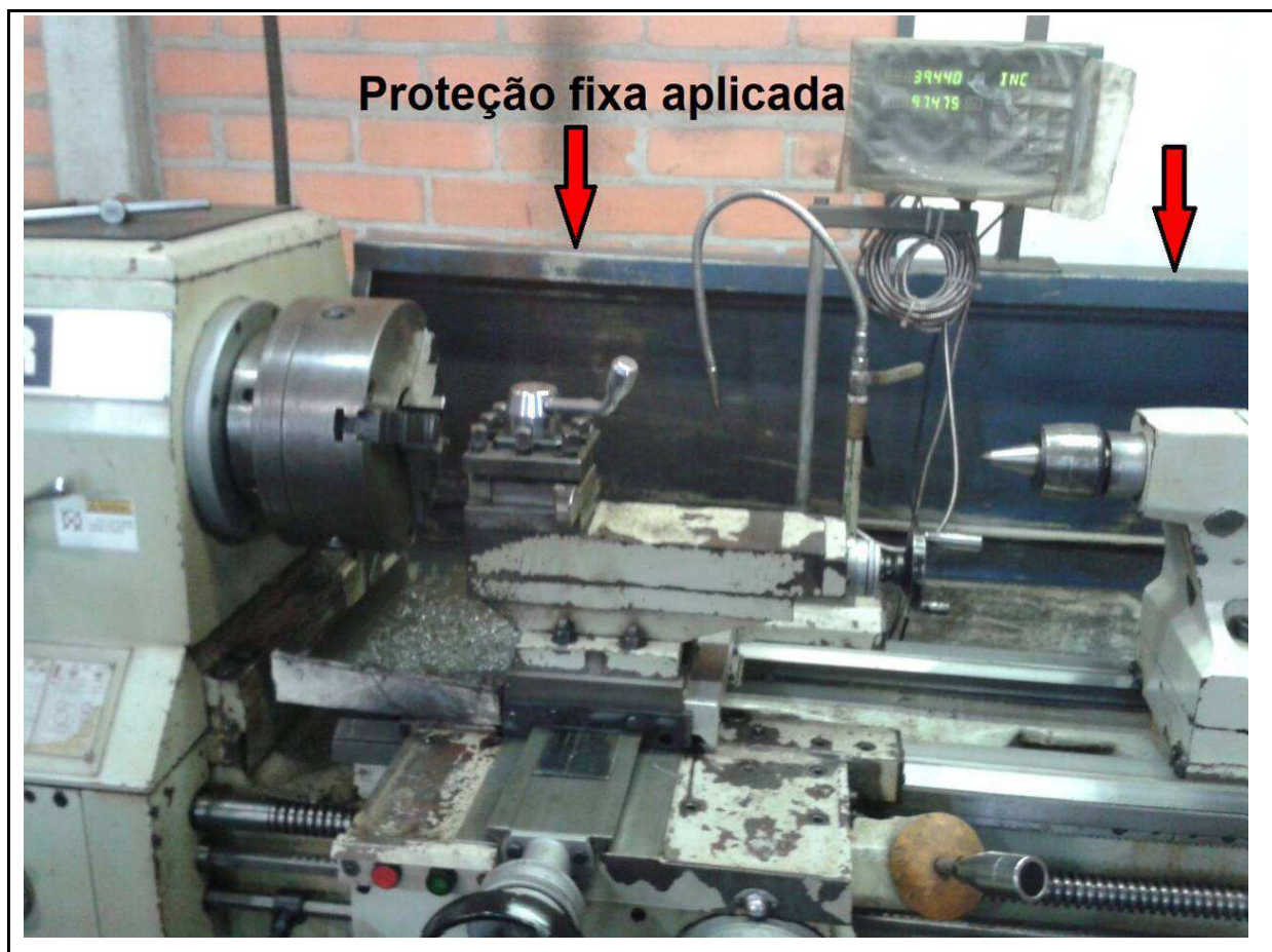
Figura 17 - Proteção fixa parte posterior torno CLEVER MODELO L-2660A.
