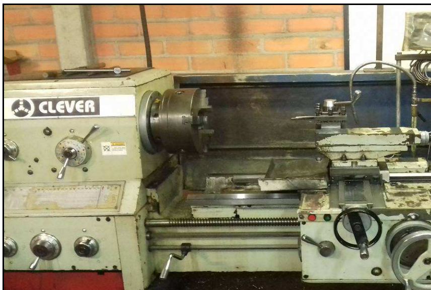
Figura 8 - Face frontal do Torno CLEVER MODELO L-2660A sem proteção.
