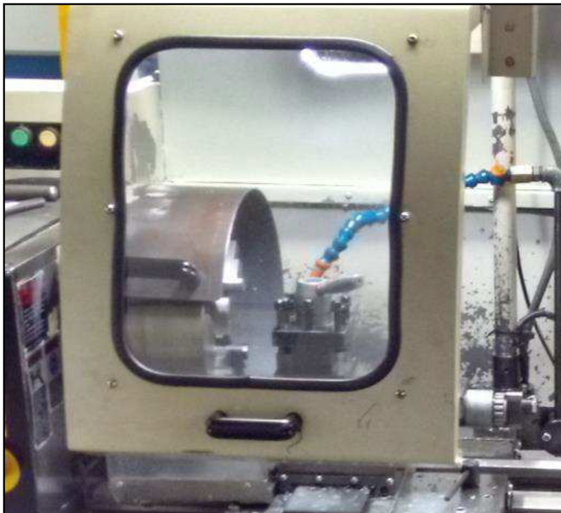
Figura 10 - Exemplo de ferramenta de corte de um torno com proteção móvel aplicada com intertravamento.
