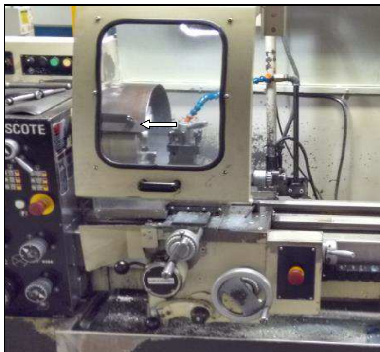
Figura 9 - Exemplo de placa com proteção móvel aplicada em um torno, conforme exigências da NR-12.
