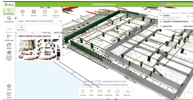
Figura 27 – Verificação execução das estacas raiz no Dalux
