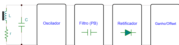
Fig. 4. Diagrama de blocos da medição de entreferro, do autor.
