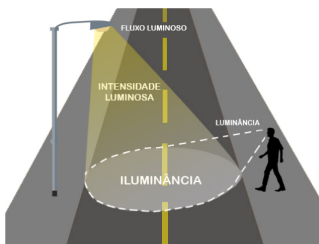
Figura 2 – Representação das grandezas fotométricas fluxo luminoso, iluminância e luminância
