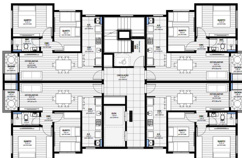
Figura 19 – Planta do pavimento tipo
