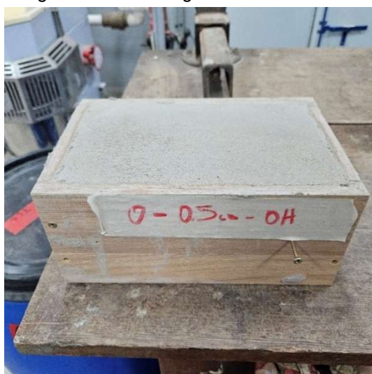
Figura 06a – Moldagem de revestimento
