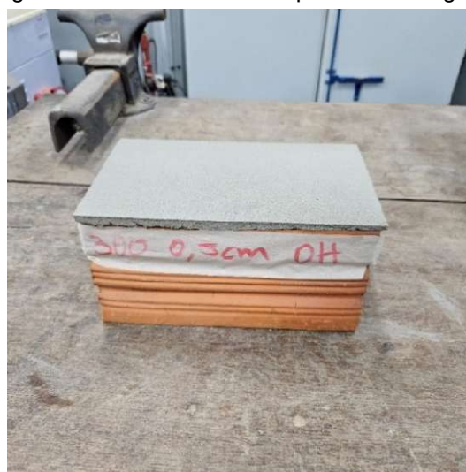
Figura 06b – bloco revestido pós desmoldagem
