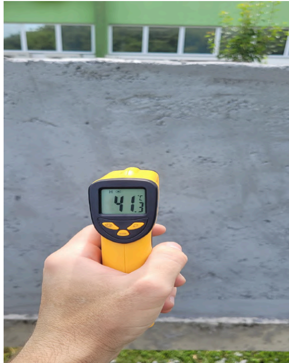
Imagem 4 - Temperatura superficial do substrato no dia do assentamento
