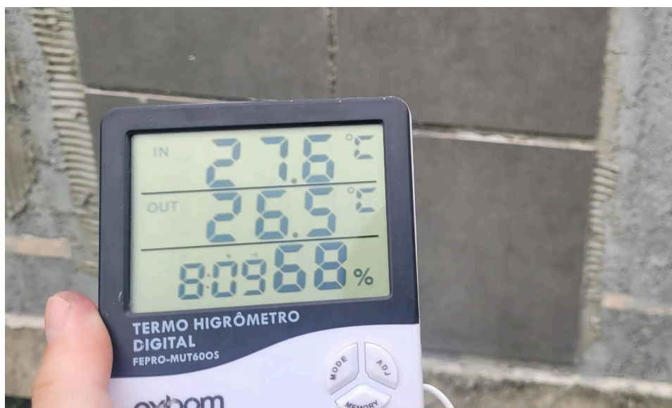
Imagem 10 - Temperatura ambiente e umidade no dia da colagem
