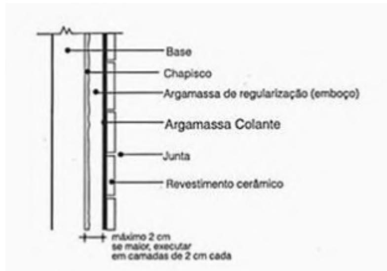
Figura 1 - Revestimento de Paredes com Argamassa Colante
