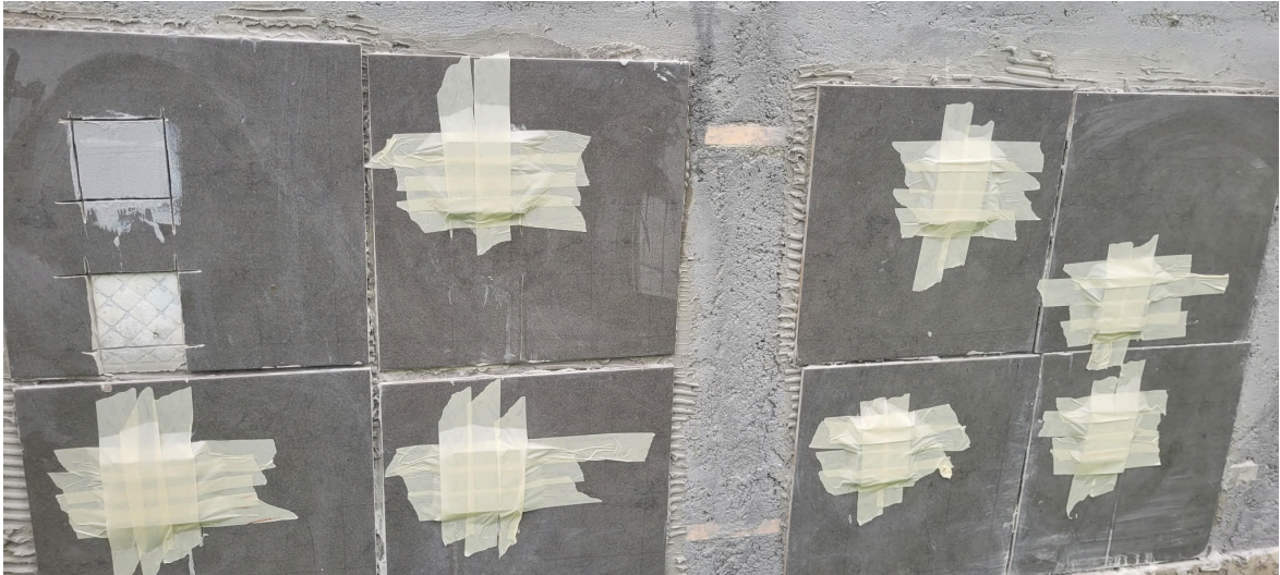
Imagem 9 - Colagem das pastilhas metálicas
