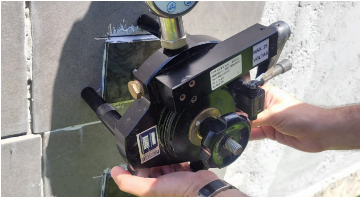
Imagem 12 - Ensaio de arrancamento
