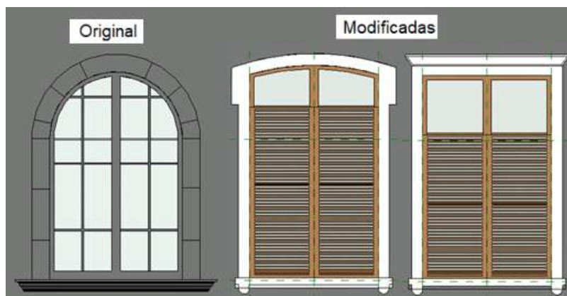
Figura 52 – Famílias original e modificadas de janelas da fachada
