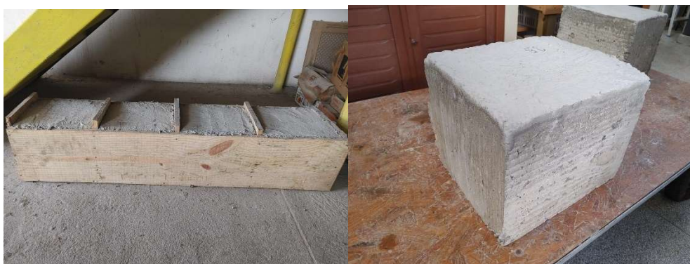
Figura 3.4 – Prismas moldados em formas de madeira
