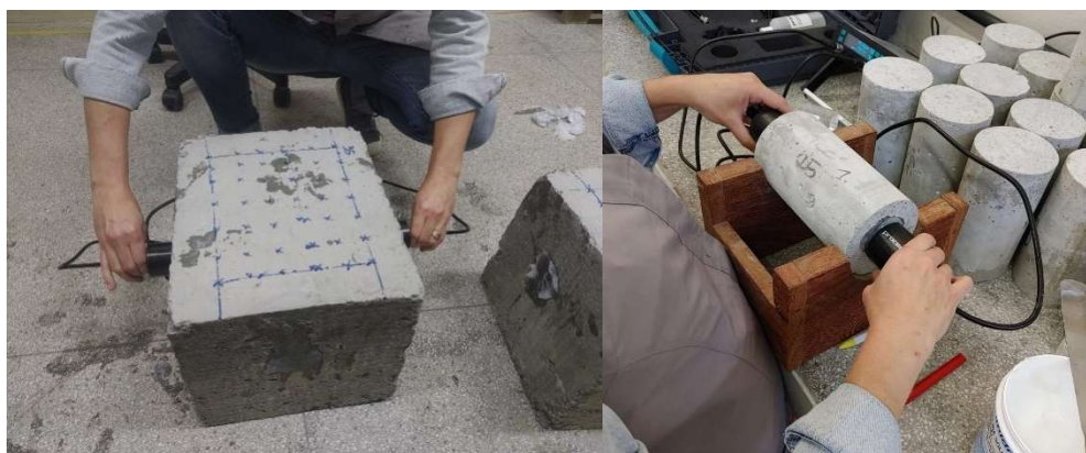
Figura 3.5 – Aplicação do ultrassom nos prismas e em corpos de prova cilíndricos no modo direto
