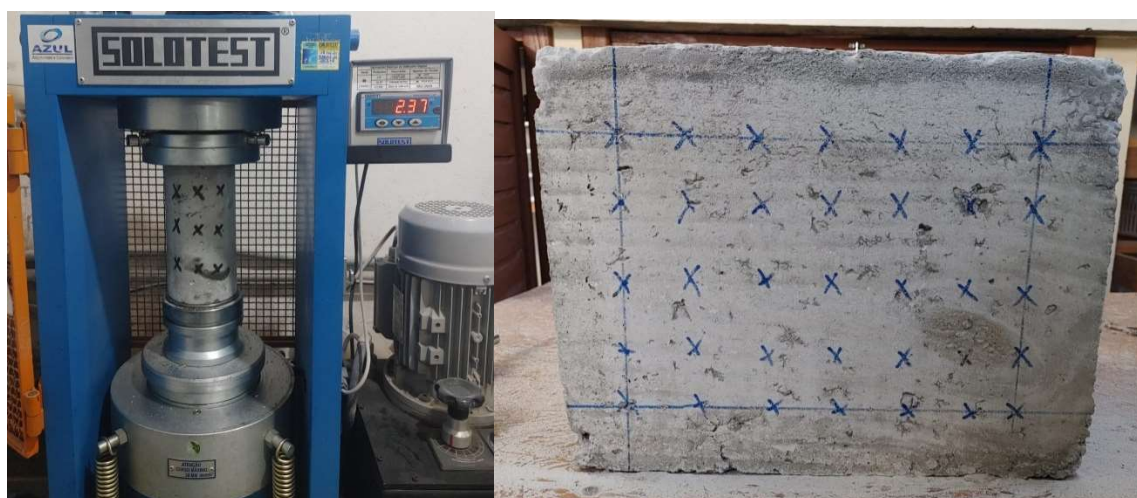
Figura 3.7 – Identificação dos pontos onde foram realizados o ensaio de esclerometria no corpo de prova e no prisma
